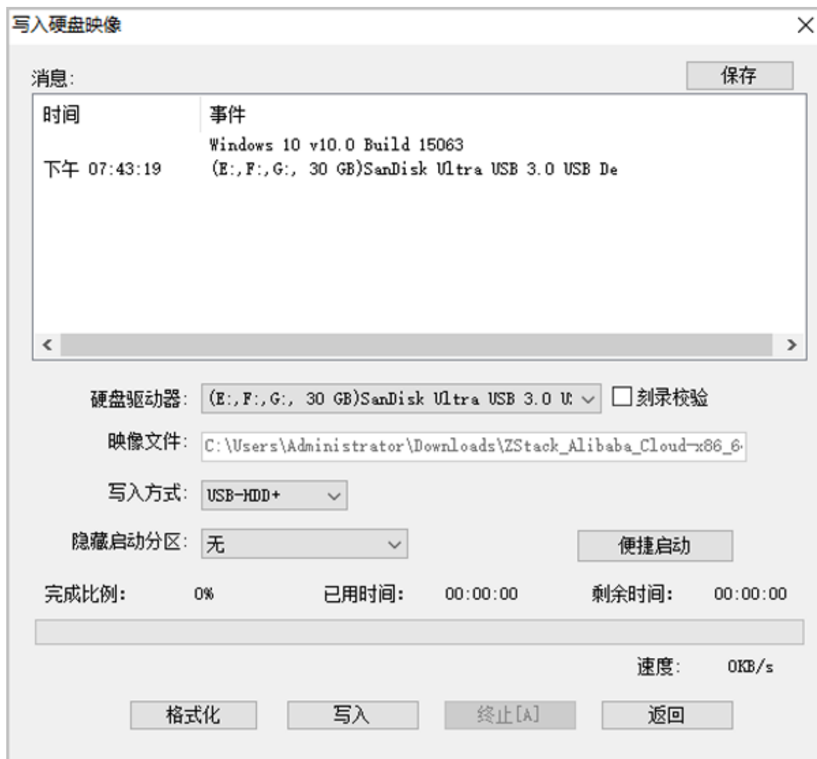
图 3-3: 在UltraISO确认写入ISO镜像
