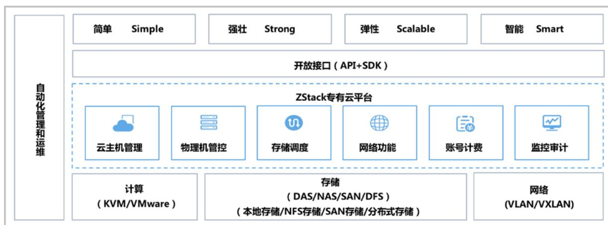
ZStack提供了对企业数据中心基础设施的计算、存储、网络等资源的管理，底层支持KVM和VMware虚拟化技术，支持DAS/NAS/SAN/DFS等存储类型，支持本地存储、NFS存储、SAN存储、分布式块存储，支持VLAN/VXLAN等网络模型。
