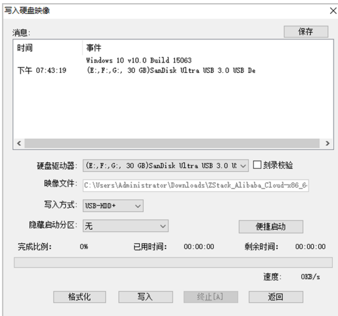
图 2-3: 在UltraISO确认写入ISO镜像
