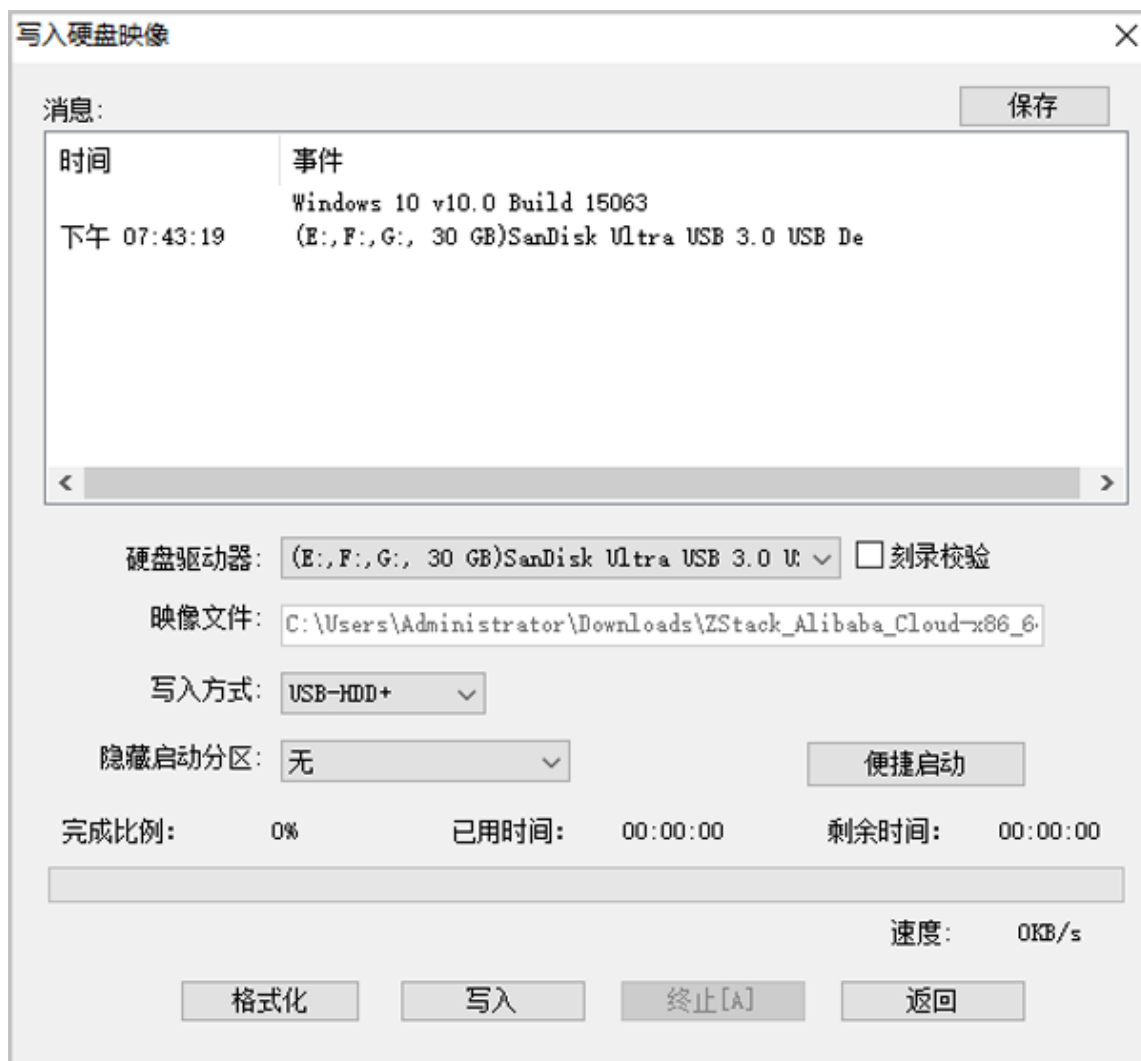
图 5-3: 在UltraISO确认写入ISO镜像
