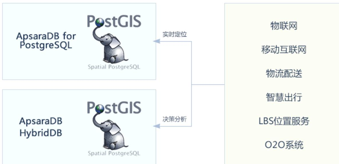
云数据库HybridDB for PostgreSQL已经内置支持符合OpenGIS标准的空间数据库引擎PostGIS，可以实现实时的定位及路径规划。同时PostGIS也是被业界广泛支持的空间数据库引擎，支持厂商包括：ArcGIS、Intergraph、QGIS等。用户只需在应用程序中使用简单的SQL，配合GIS函数操作，即可处理复杂的空间地理数据模型（支持2D及3D处理）。
