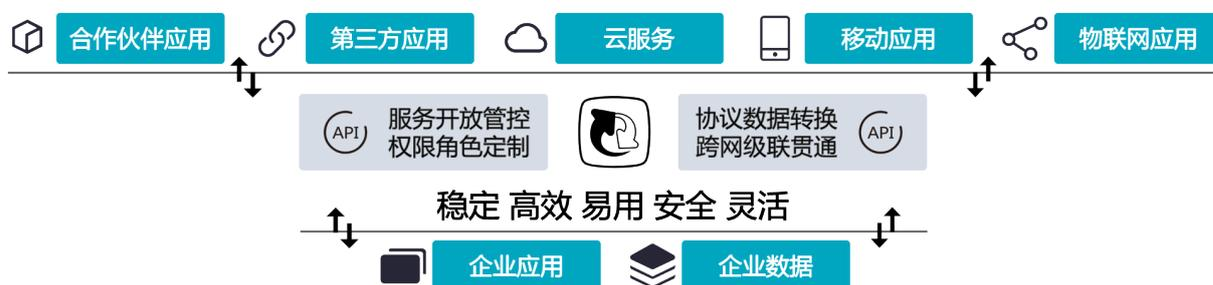
如下图所示，云服务总线 CSB 可以把企业内外应用所提供的服务发布成 API，供消费方订阅调用，并提供审批授权、服务管控和计量监控等能力。而且不仅仅是把内部服务开放到外部，如图中标号为 ① 到 ④ 所示，可以是内到内、内到外、外到内、外到外各种方向的灵活开放方式。而且如其中 ② 所示的开放方式，以及 ③ 和 ④ 的组合效果所示，一个服务可以同时开放成具有多个不同协议入口、甚至是不同开放方向的 API。
