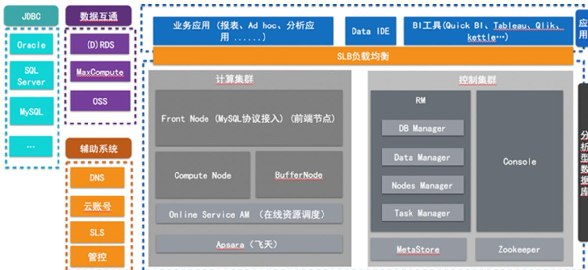
AnalyticDB (原ADS) 是构建在阿里云分布式操作系统飞天之上的基于MPP架构并融合了分布式检索技术的分布式实时计算系统。如图所示，Analytic DB的主体部分主要由四个部分组成：
