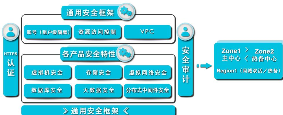
阿里云专有云提供了同城的容灾备份方案。同城 ( 50KM ) 以内，可通过负载均衡实现无状态服务的双机房双活，以及结构化数据热备方案，实现秒级RTO和RPO。异地 ( >50KM ) 可提供数据冷备方案，根据网络情况，可实现分钟级或者小时级RTO和RPO。
