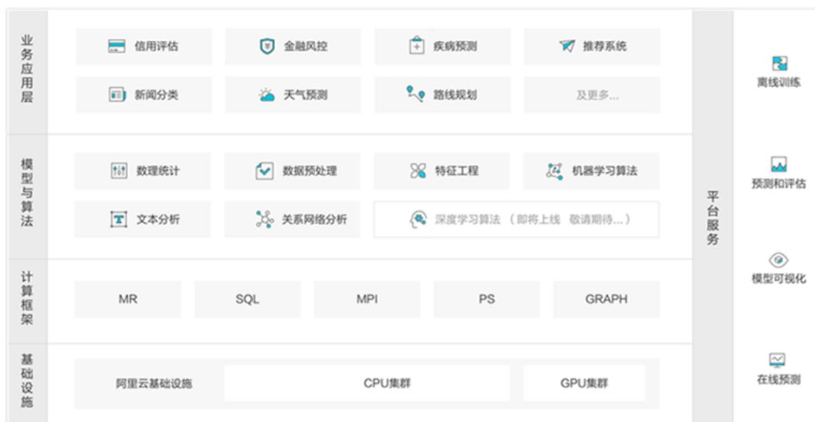
上图是 PAI 整体框架图，最底层是基础设施层，包括 CPU 和 GPU 集群；其上一层是阿里提供的计算框架，包括 MapReduce/SQL/MPI 等计算方式；中间一层是模型算法层，包含数据预处理，特征工程，机器学习算法等基本组件，帮助使用者完成简单的工作；平台化产品主要是项目管理、算法模型分享，以及一些特定的需求；最上层是应用层，阿里内部的搜索、推荐、蚂蚁金服等项目在进行数据挖掘工作时，都是依赖 PAI 平台产品。
