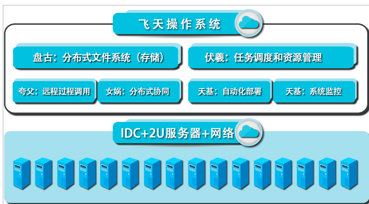
图 7: 飞天内核系统架构
