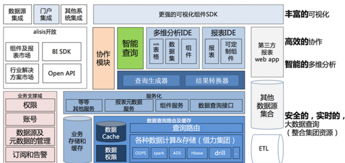
图 31-12: 数据平台整体技术架构
